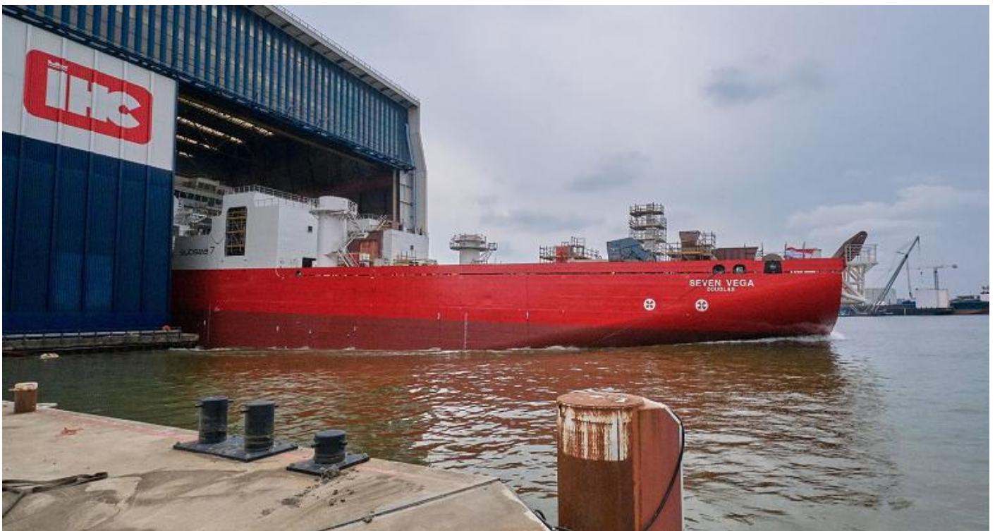
Isle of Man. 21.334 GT, 6.400 NT, 10.800 DWT. 149,20 x 33,00 x 13,00 x 8,300 meter. 3 motoren van elk 3.500 kW, 3 generatoren van elk 4.000 kW. (Foto: IHC).
